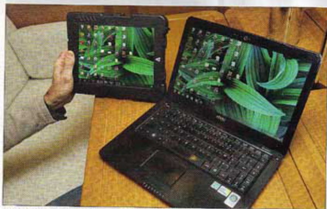
▲ Une simple application gratuite (VNC Lite) permet d'utiliser l'iPad comme un répéteur actif du PC resté à la table à cartes.
