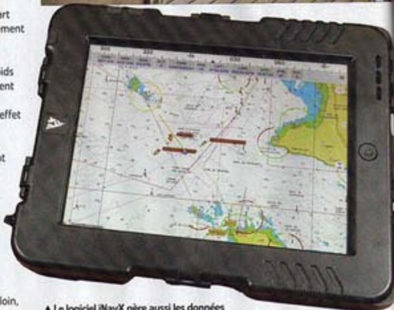
▲ Le logiciel iNavX gère aussi les données fournies en Wi-Fi par le boîtier AIS (voir page suivante).
