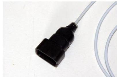
5. C'est fini ! La bande noire auto-adhésive va fusionner rapidement avec le temps pour former un bloc très solide. Il peut être nécessaire de remplir la jonction entre le câble et le connecteur avec un peu de colle pour parfaire l'étanchéité
